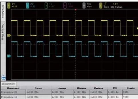
示波器测量 1KHz · 2.5Vpp 的方波
