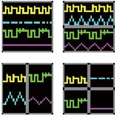
多窗口功能提供 4 种显示方式 ( 1x1、2x1、1x2、2x2 )，最多可在 4 个不同的窗口中显示 16 个通道，在不降低垂直解析度的情况下提供清晰可读的波形。
