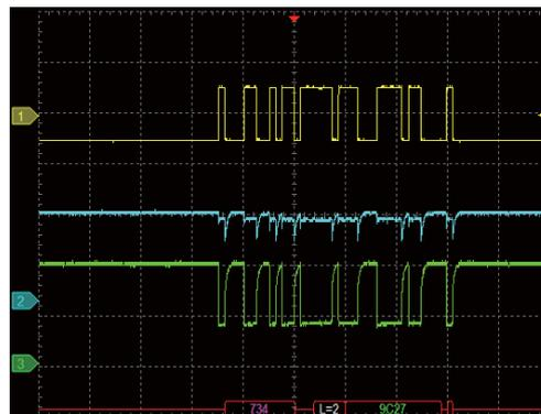
以示波器搭配差分探头测量并解码 CAN 波形
