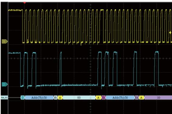
以示波器测量并解码 I<sup>2</sup>C 波形
